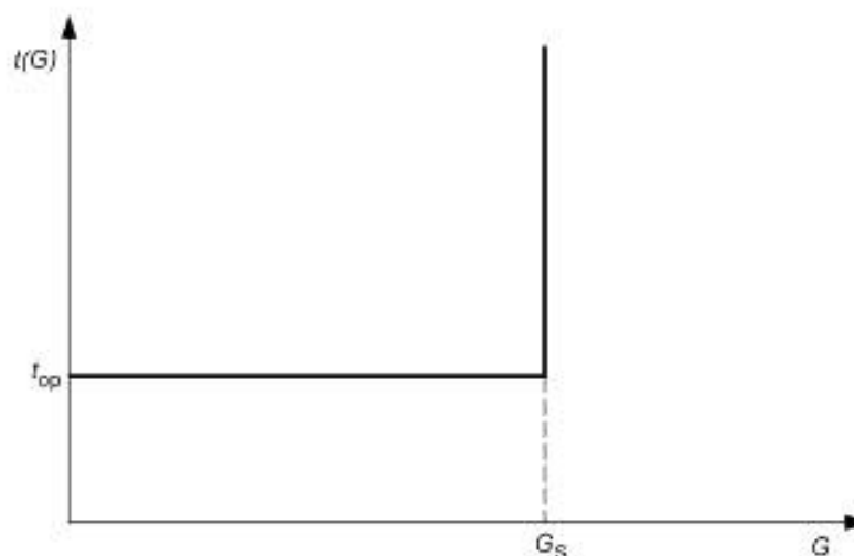
Рисунок 3 — Независимая характеристика времени реле минимального тока
