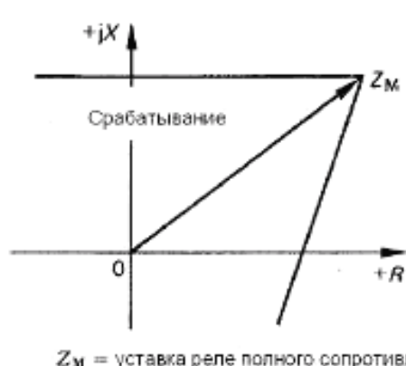
Рисунок 1б — Характеристика реактивного сопротивления
