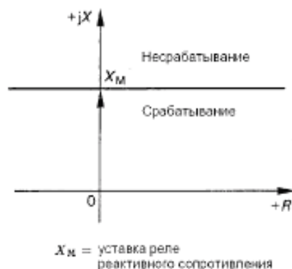
Рисунок 1б — Характеристика реактивного сопротивления
