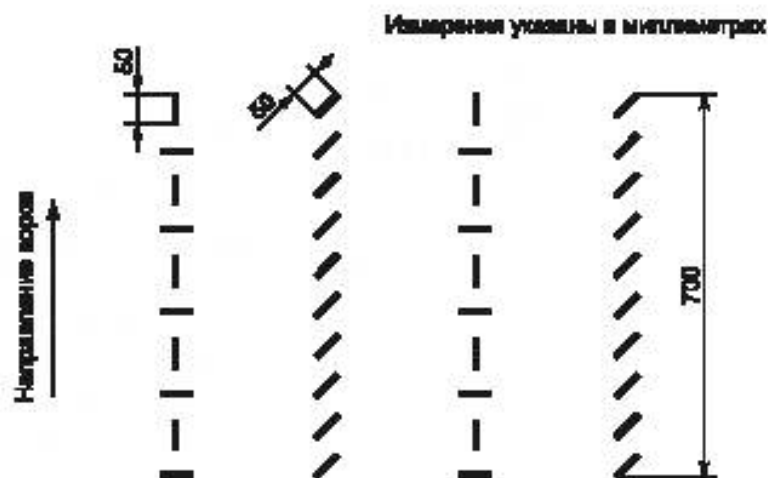
Рисунок 7 — Расположение нитей в испытании по удалению нити
