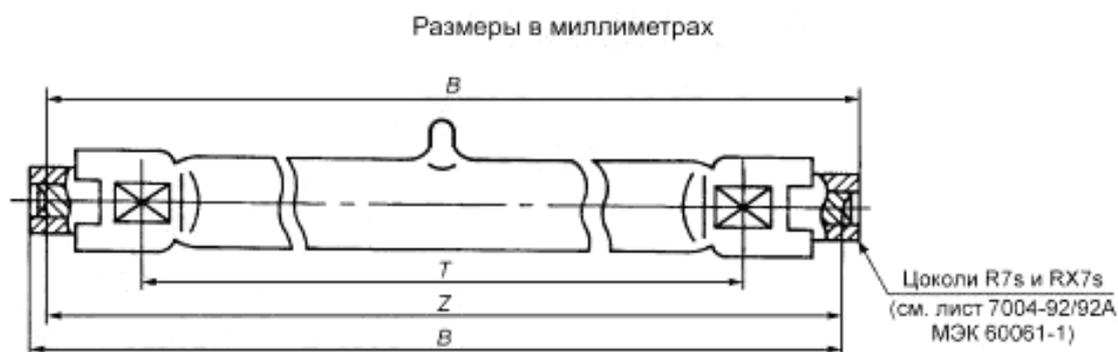
Размер  $Z_{\text{НОМ}}$  — это расстояние между основаниями контактов,  $B_{\text{МАКС}}$  и  $E_{\text{НОМ}}$  указаны в соответствующем листе на лампу.
