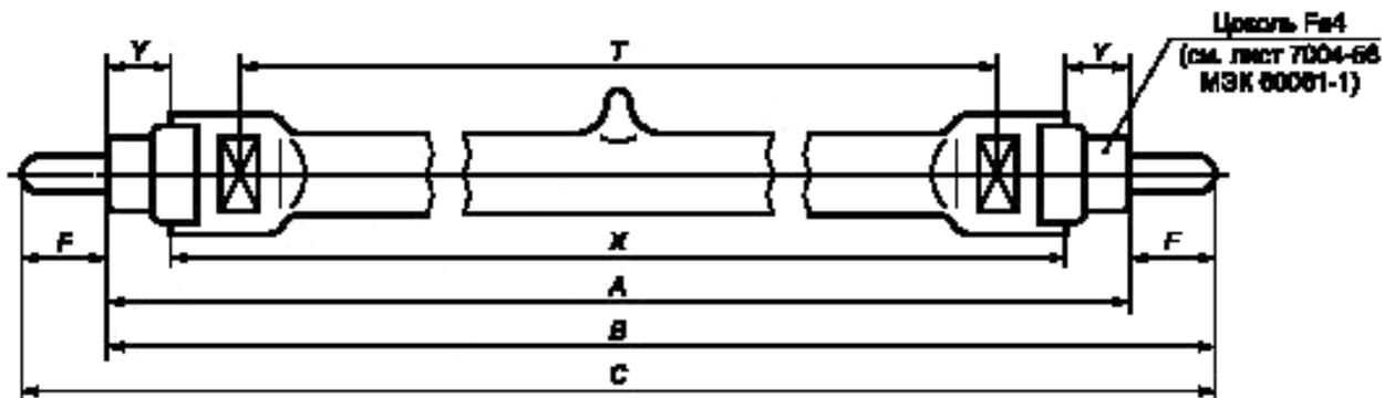
$X$  означает номинальную длину защитного кожуха. Допуск на размер  $X$  составляет  $\pm 1,5$  мм. Размер  $Y$  берется равным  $(7,5 \pm 0,15)$  мм. Размеры  $X$  и  $Y$  приводятся только для пояснения нанесения размеров и не проверяются на лампе.
