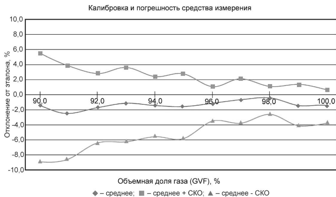
Рисунок А.2 — Кривая погрешности в результате калибровки
