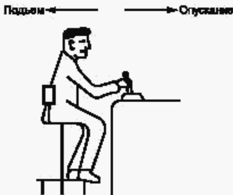
Рисунок 6 — Рекомендуемые направления движения руки оператора при использовании органа управления (в виде рычага) процессом подъема и опускания объекта
