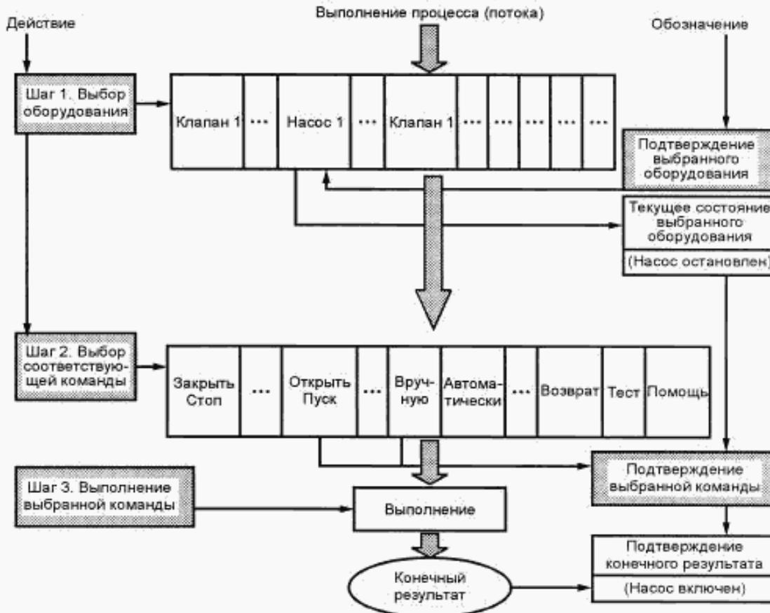
Рисунок 2 — Трехшаговая последовательность выполнения многофункционального применения
