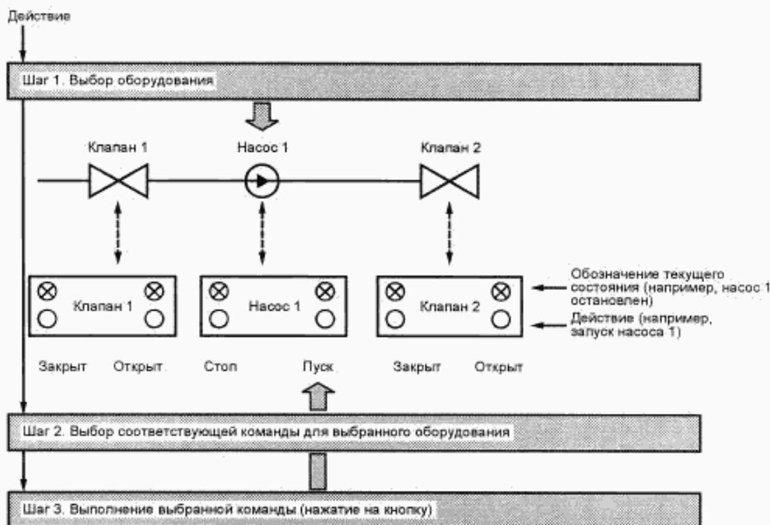
Рисунок 1 — Трехшаговая последовательность выполнения однофункционального применения
