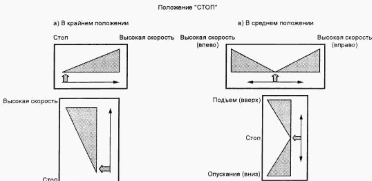
Рисунок 3 — Положение «СТОП» ползунка (пример линейного перемещения)
