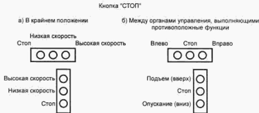
Рисунок 4 — Кнопка «СТОП» в наборе органов управления
