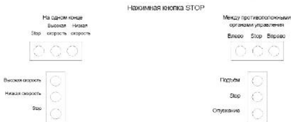
Рисунок 4 — Нажимная кнопка STOP в составе группы органов управления
