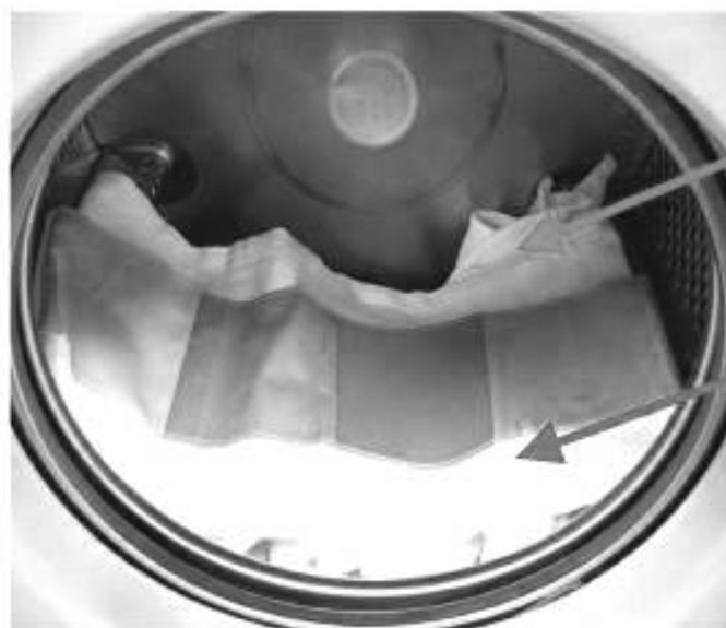
Рисунок Н.10 — Стиральная машина с горизонтальной осью: расположение предметов в барабане
