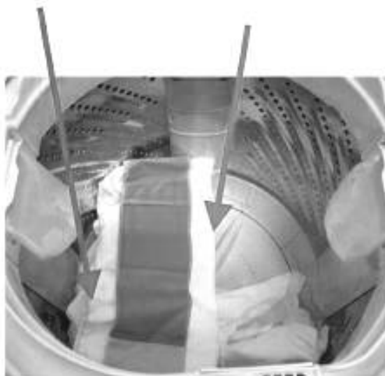
Рисунок Н.11 — Стиральные машины с вертикальной осью: расположение предметов в барабане
