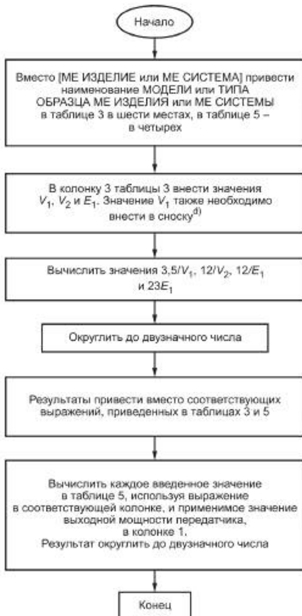
Рисунок 4 — Порядок заполнения таблиц 3 и 5 для МЕ ИЗДЕЛИЙ и МЕ СИСТЕМ ЖИЗНЕОБЕСПЕЧЕНИЯ (см. 5.2.2.2)
