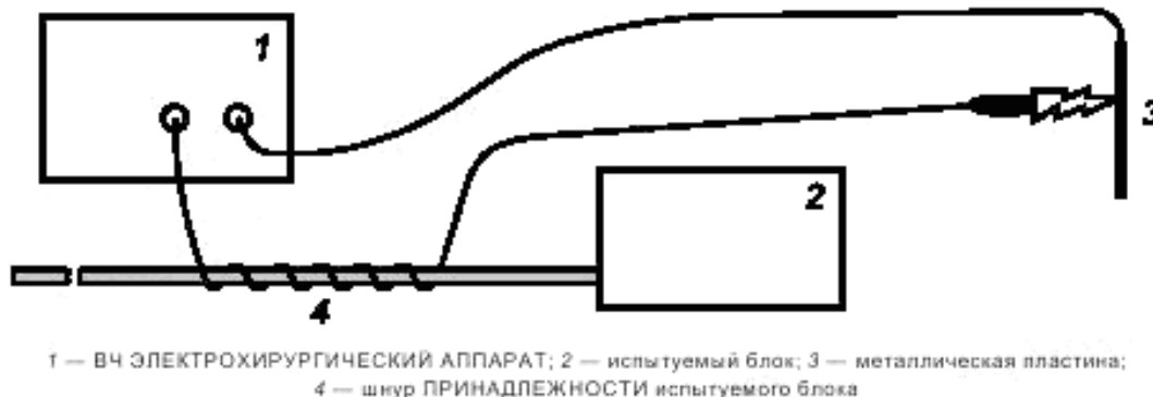
Рисунок ВВ.6 — Специальное испытание шнура питания
