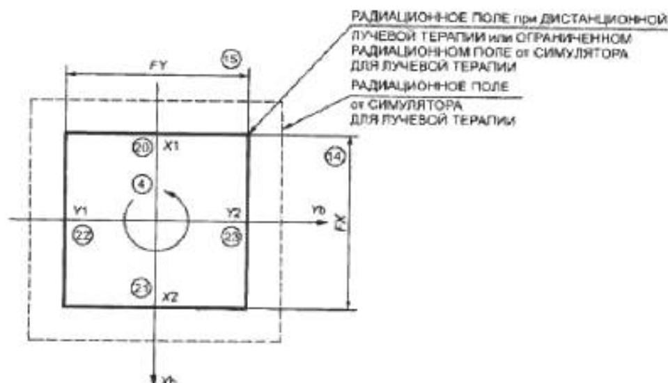
Рисунок 103 – Движения и шкалы. Вид от ИСТОЧНИКА ИЗЛУЧЕНИЯ на РАДИАЦИОННОЕ ПОЛЕ или ОГРАНИЧЕННОЕ РАДИАЦИОННОЕ ПОЛЕ СИМУЛЯТОРА для ЛУЧЕВОЙ ТЕРАПИИ
