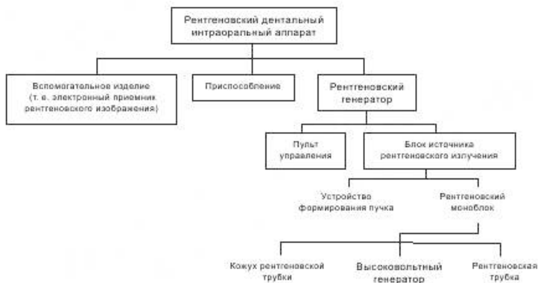
Рисунок ВВ.1 — Структура РЕНТГЕНОВСКОГО ДЕНТАЛЬНОГО ИНТРАОРАЛЬНОГО АППАРАТА
