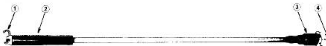
1 — крюк зацепления; 2 — защитный рукав; 3 — гнездо; 4 — ушко
