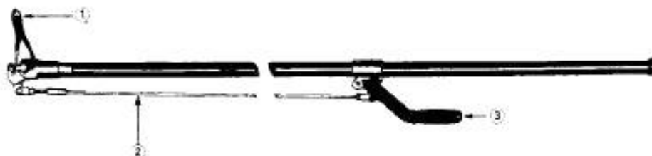
1 — кусачки; 2 — тяга; 3 — рычаг управления
