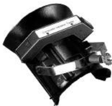
Тестер изоляции гирлянды (на принципе измерения электрического поля)
