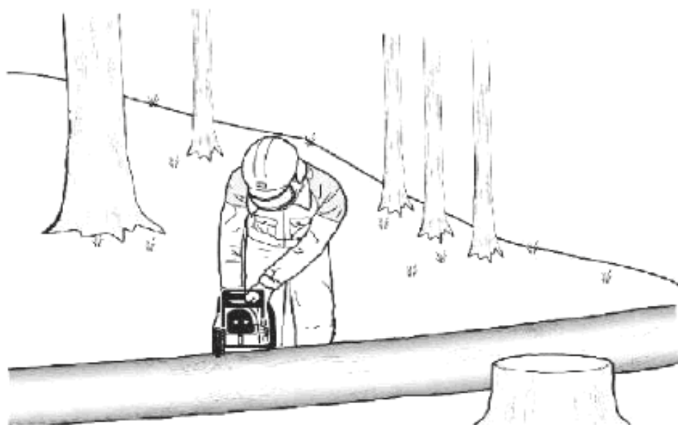
При резке стоять на верхней стороне, так как хлыст может покатиться
