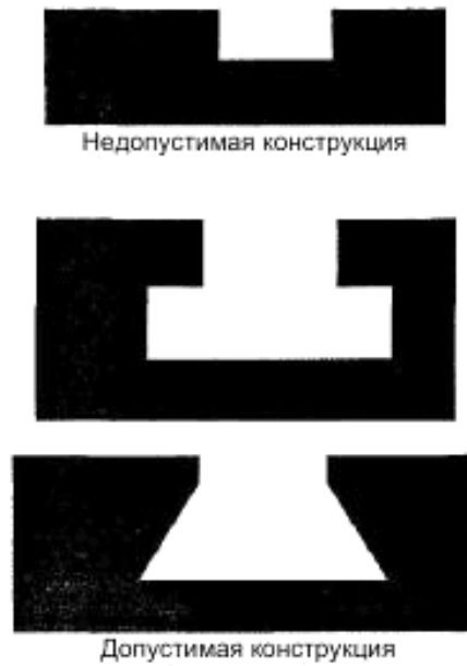
Рисунок М.306 – Примеры геометрии паза для размещения линейки в целях поперечной распиловки на столах для пил
