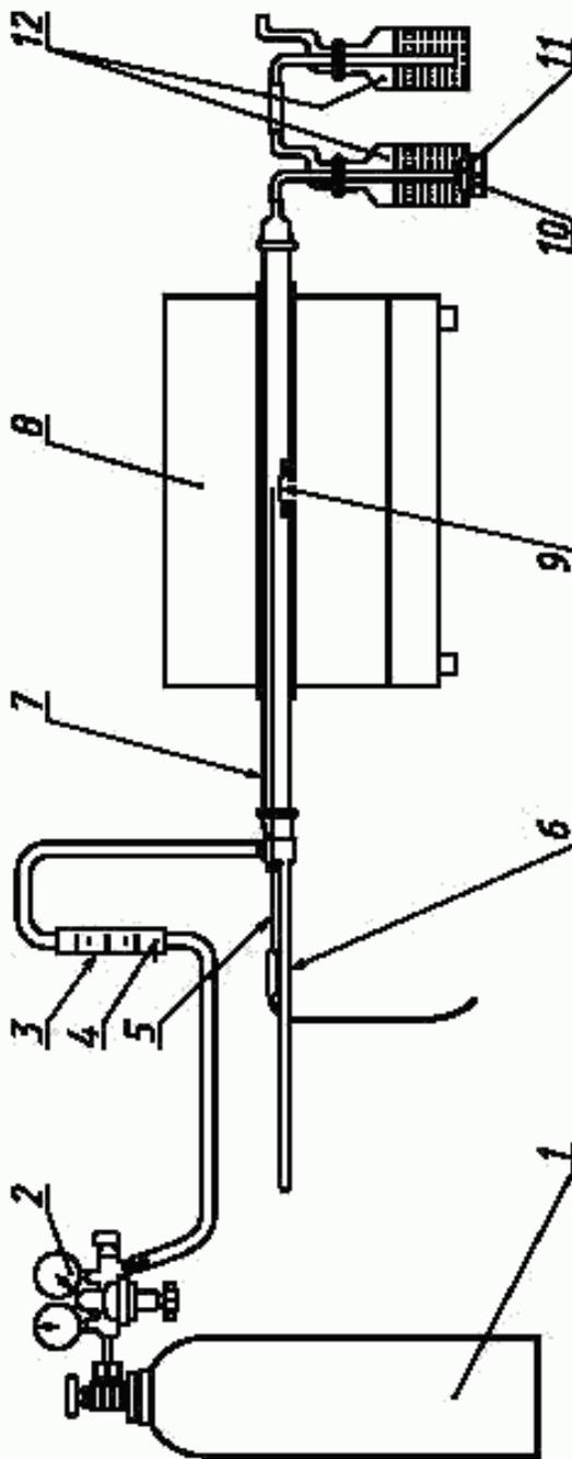
1 — баллон с искусственным воздухом; 2 — редуктор; 3 — ротаметр; 4 — игольчатый вентиль; 5 — термометр; 6 — устройство для ввода лодочки с образцом; 7 — трубка из кварцевого стекла; 8 — печь; 9 — лодочка с образцом; 10 — магнитная мешалка; 11 — стержень магнитной мешалки; 12 — промывочные сосуды
