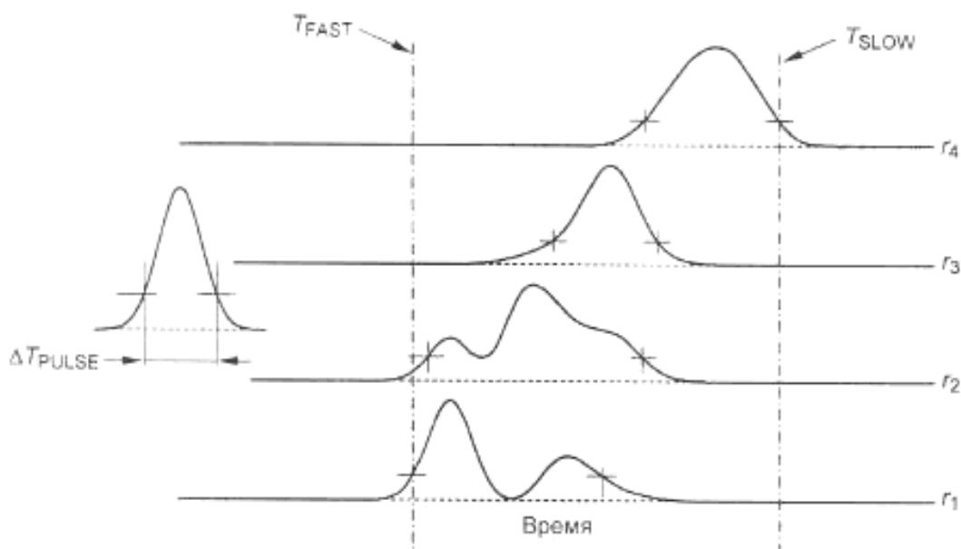
**П р и м е ч а н и е** — Значения времени переднего и заднего фронта (пороговые значения на уровне 25 % пикового значения) обозначены знаком «+». Графики сдвинуты с учетом положений возбуждения. На врезке показано  $\Delta T_{PULSE}$ .
