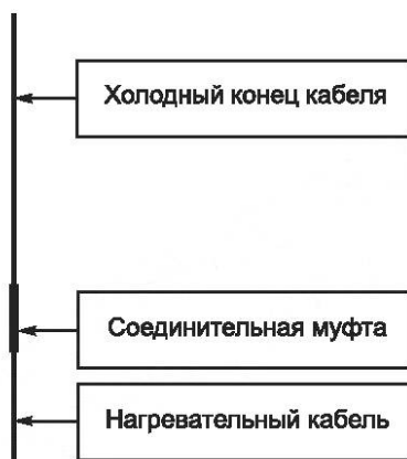
Рисунок 1 — Типовое расположение компонентов при испытании соединительной муфты
