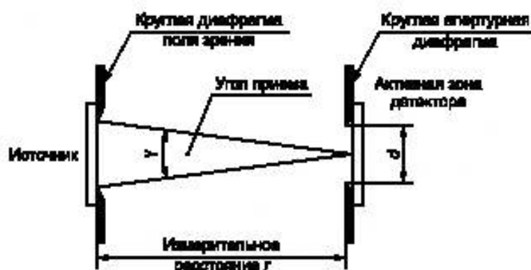
Рисунок 8б — Измерительная установка для доступного источника
