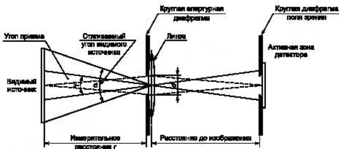
Рисунок 8а — Измерительная установка с изображением источника
