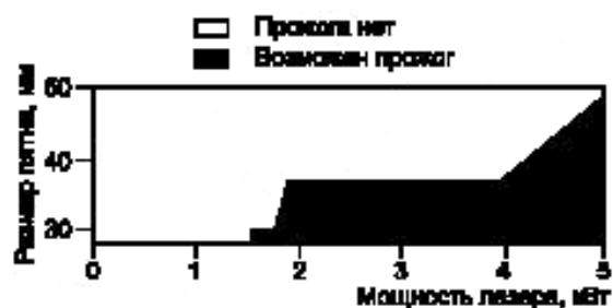
Рисунок F.7 — Стойкость к разрушению листа алюминия толщиной 2 мм от 10 с экспозиции расфокусированного пучка во время экспериментов с использованием непрерывного лазера на углекислом газе
