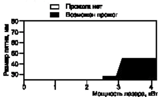
Рисунок F.15 — Стойкость к разрушению листа оцинкованной стали толщиной 2 мм от 10 с экспозиции расфокусированного пучка во время экспериментов с использованием непрерывного лазера на иттрий-алюминиевой гранате с неодимом
