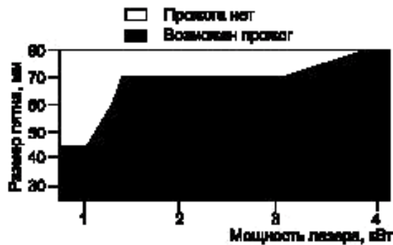
Рисунок F.14 — Стойкость к разрушению листа оцинкованной стали толщиной 1 мм от 100 с экспозиции расфокусированного пучка во время экспериментов с использованием непрерывного лазера на иттрий-алюминиевой гранате с неодимом
