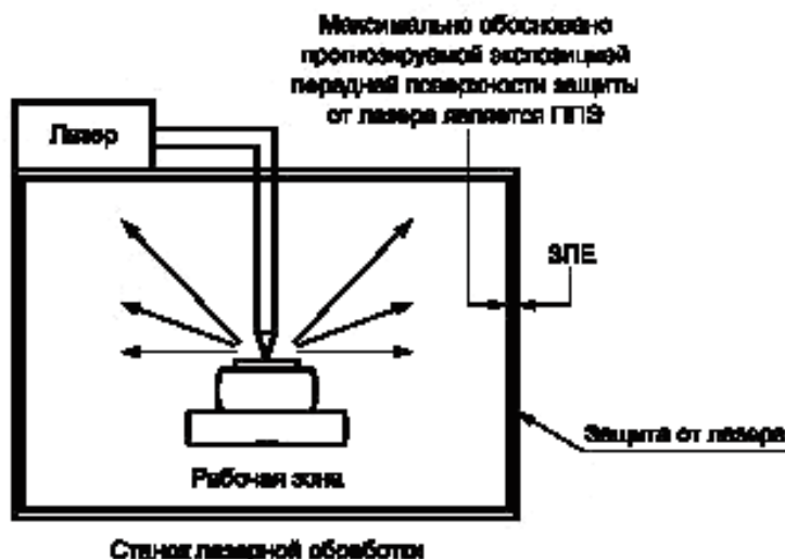
Рисунок С.1 — Пример защиты вокруг станка лазерной обработки
