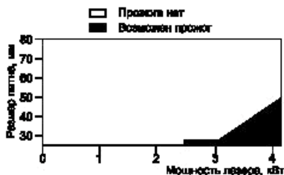
Рисунок F.17 — Стойкость к разрушению листа оцинкованной стали толщиной 3 мм от 10 с экспозиции расфокусированного пучка во время экспериментов с использованием непрерывного лазера на иттрий-алюминиевой гранате с неодимом
