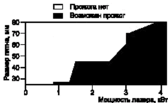
Рисунок F.16 — Стойкость к разрушению листа оцинкованной стали толщиной 2 мм от 100 с экспозиции расфокусированного пучка во время экспериментов с использованием непрерывного лазера на иттрий-алюминиевой гранате с неодимом
