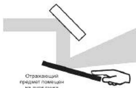
Рисунок В.4d — Отражающий предмет пересекает пучок лазера
