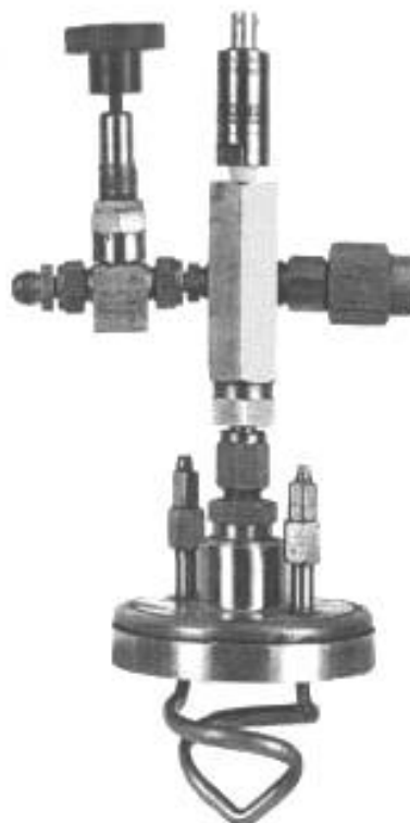
Рисунок 3 — Крышка с охлаждающим змеевиком
