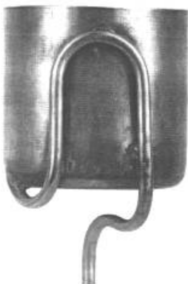
Высота чашки — (82 \pm 5) мм; диаметр чашки — (84 \pm 5) мм; диаметр трубки — (5 \pm 1) мм
