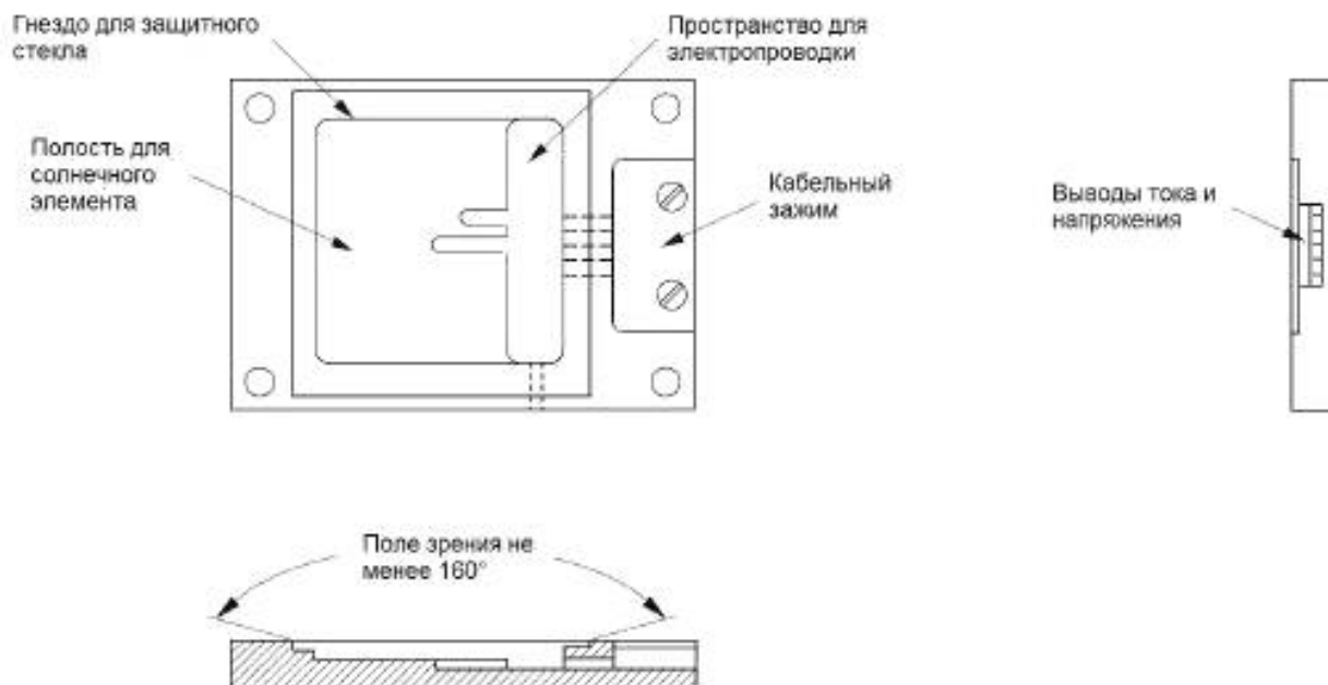
Рисунок 2 – Корпусирование одиночного солнечного элемента.
