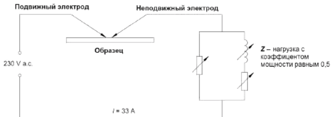
Рисунок М.2 – Схема испытания на воспламеняемость электрической дугой
