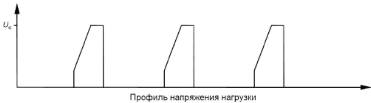
Рисунок F.3 – Профиль испытания на блокирующую и коммутационную способность
