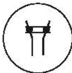
Рисунок L.2 — Символ маркировки аппарата, содержащего механически связанные контакты
