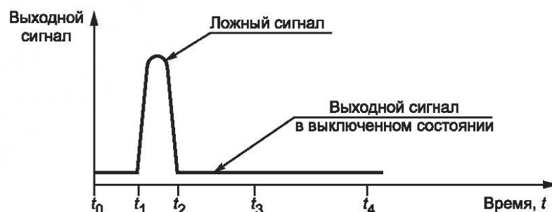
б) Коммутационный элемент в выключенном состоянии
