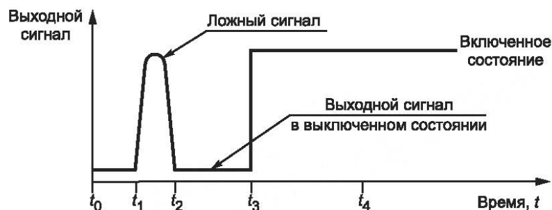
а) Коммутационный элемент во включенном состоянии
