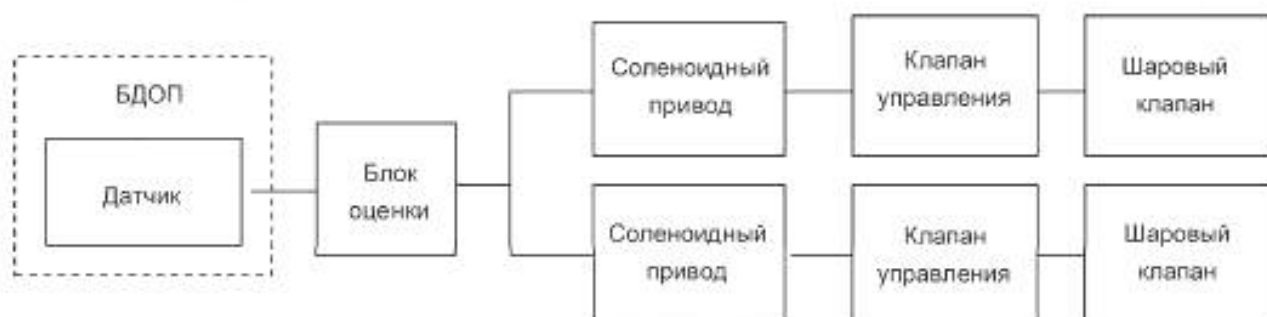
Рисунок А.2 — Архитектура функции, связанной с безопасностью
