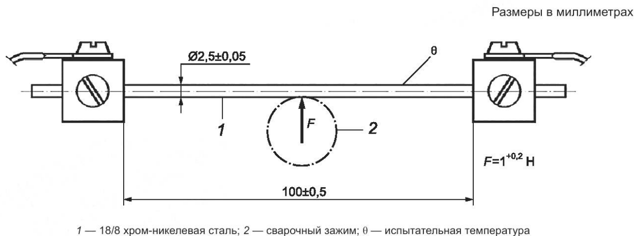
Рисунок 1 — Устройство для испытания на стойкость к воздействию горячих предметов
