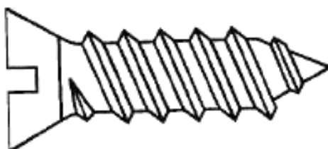
Рисунок 1 – Самонарезающий формующий винт (см. 3.6.10)
