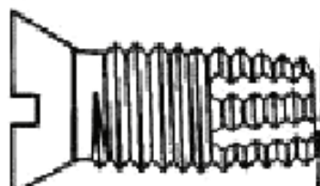
Рисунок 2 – Самонарезающий режущий винт (см.3.6.11)
