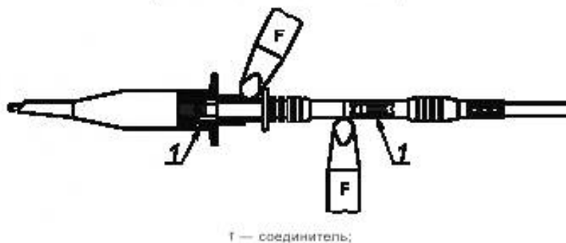
б) Полностью собранный ИЗМЕРИТЕЛЬНЫЙ ЩУП [см. 6.2 и 6.4.1 а)]
