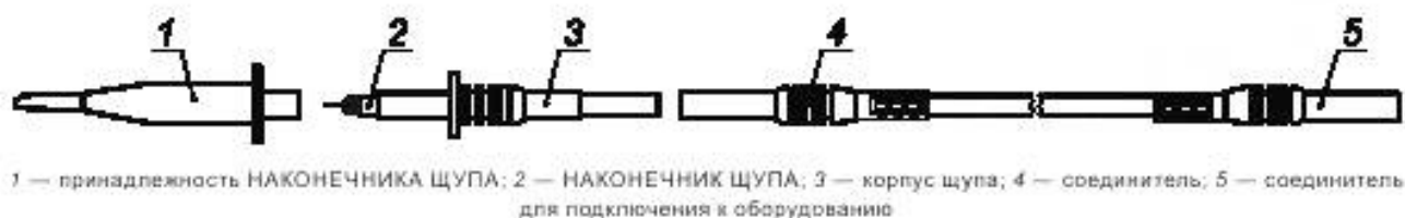
а) Части ИЗМЕРИТЕЛЬНОГО ЩУПА
