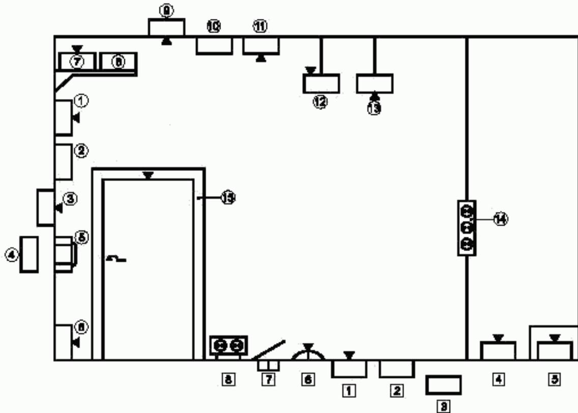
5 — место установки аппаратов в системе кабельных коробов.
