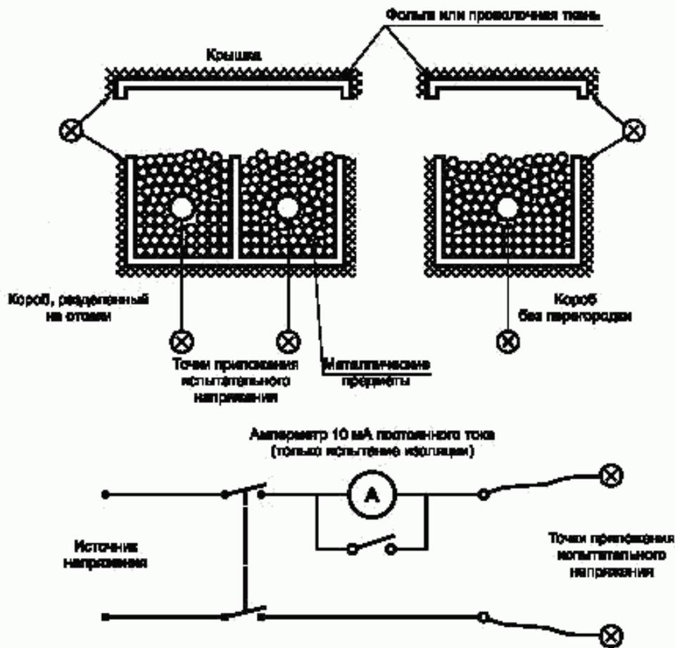
Рисунок 3 — Испытание электрической прочности изоляции и сопротивления изоляции
