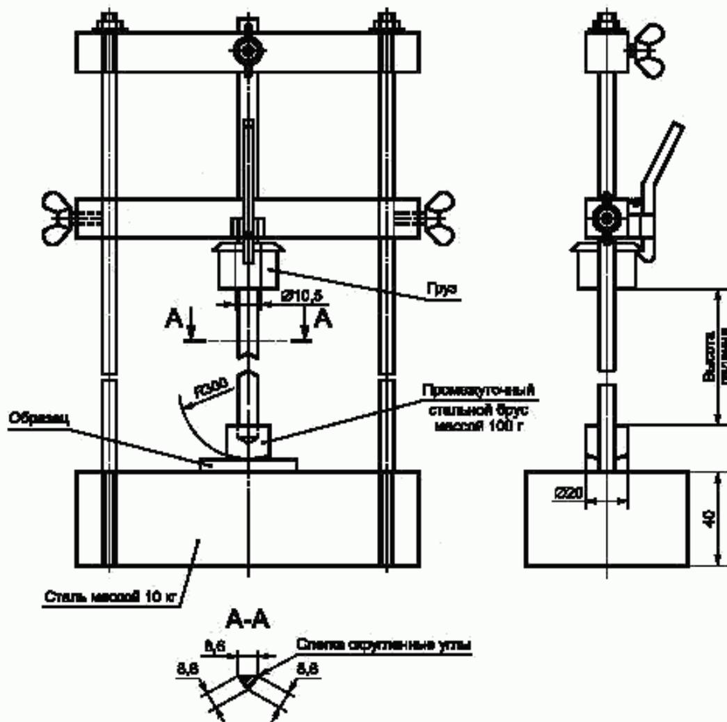
Рисунок 2 — Устройство для испытания на воздействие ударов
