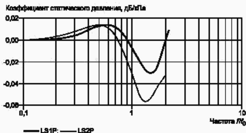
Рисунок В.1 — Зависимости коэффициента статического давления чувствительности по свободному полю микрофонов типов LS1P и LS2P от безразмерной частоты f/f_0 , где f_0 — резонансная частота микрофона
