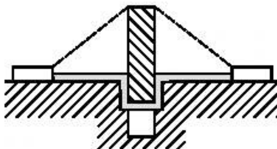
Рисунок E.8 — Расстояние утечки на примере 7
