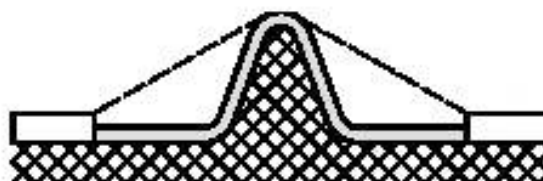
Рисунок E.4 — Расстояние утечки на примере 3
