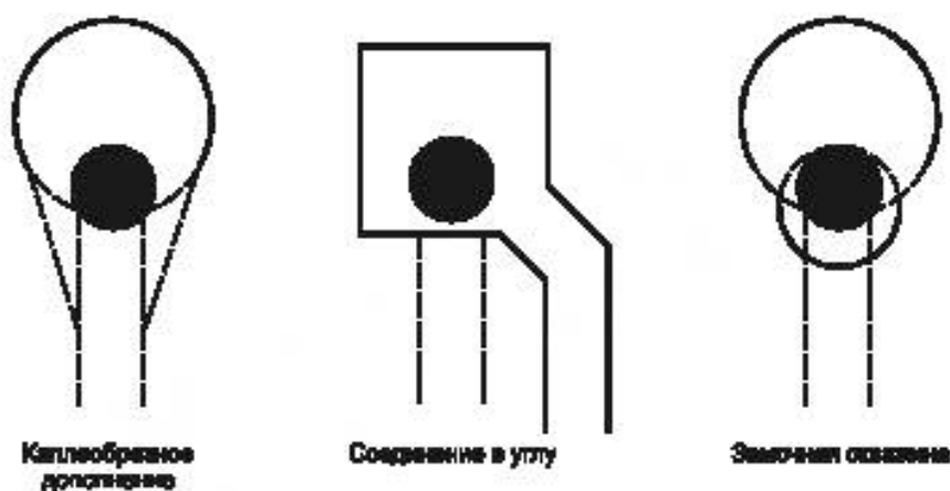
Рисунок 17 — Примеры измененных соединений проводника и контактной площадки
