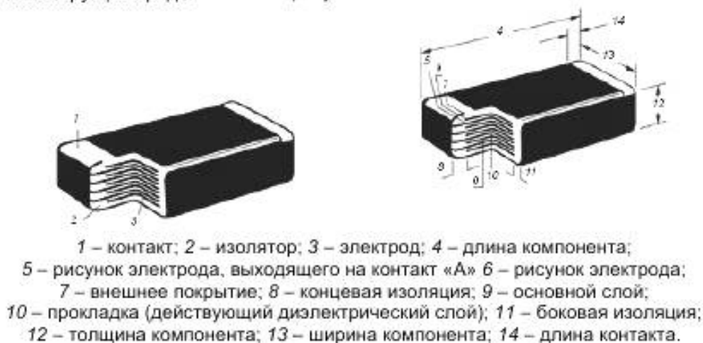
Рисунок 10 – Конструкция многослойного керамического безвыводного конденсатора
