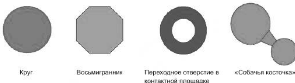
Рисунок 1 – Формы контактных площадок матричных посадочных мест
