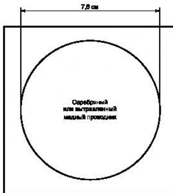
Рисунок 22с — Тестовый рисунок для определения объемного и поверхностного сопротивлений (сторона 2)
