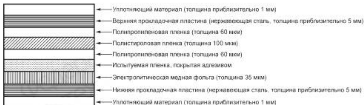
Рисунок 20 — Стандартная укладка слоев материалов в прессе при подготовке образца к арбитражным испытаниям
