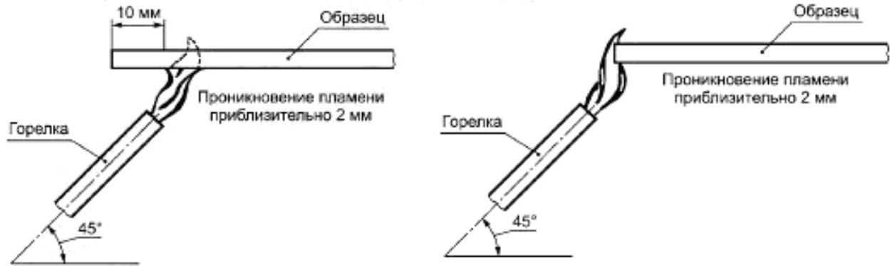
а) Горизонтальный образец. Приложение пламени к поверхности
