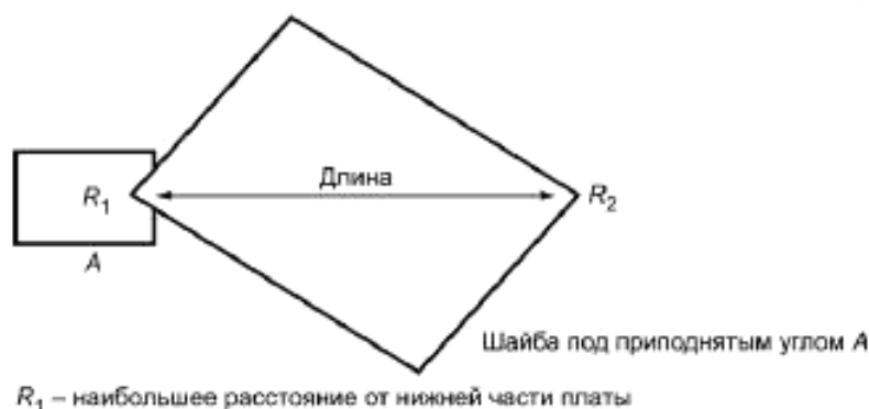
Рисунок 9 — Схема проведения измерения скручивания
