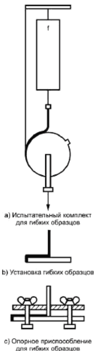
Рисунок 13 — Измерительное оборудование для испытания гибких печатных плат на отрыв
