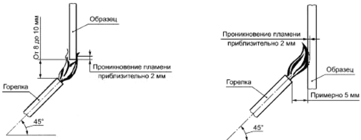
с) Вертикальный образец. Нижний край горизонтален. Приложение пламени к краю
