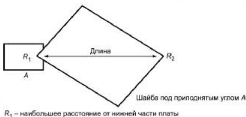
Рисунок 9 — Схема проведения измерения скручивания
