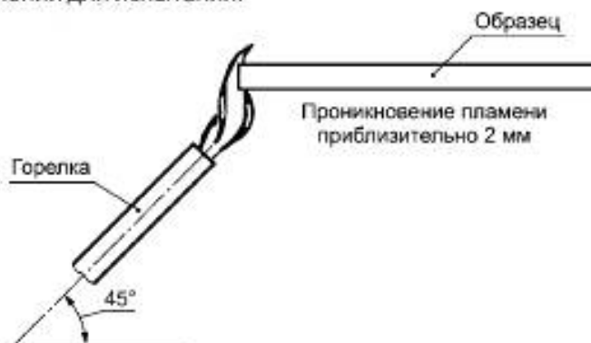
б) Горизонтальный образец. Приложение пламени к краю
