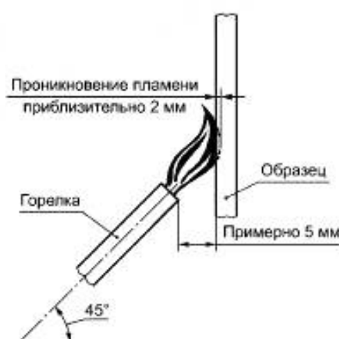
д) Нижний край горизонтален. Приложение пламени к поверхности
