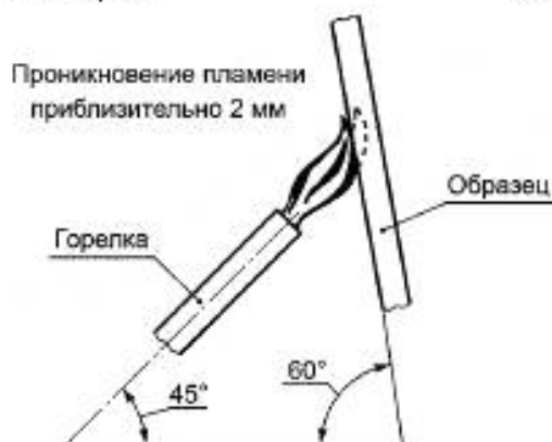
е) Испытание с использованием горелки игольчатого типа. Виды сбоку на тест-плату и горелку
