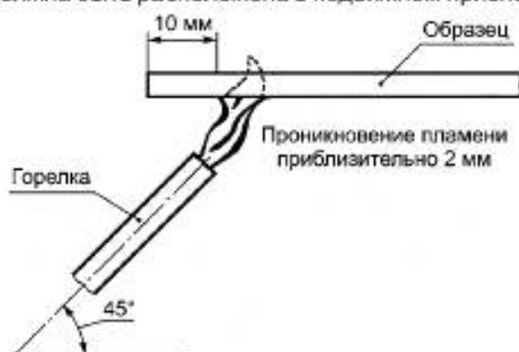
а) Горизонтальный образец. Приложение пламени к поверхности
