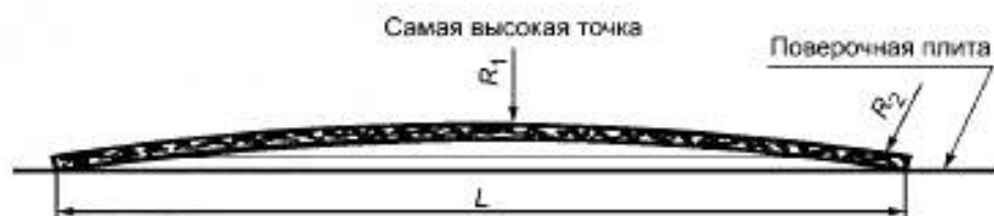
Рисунок 8 — Схема проведения измерения изгиба
