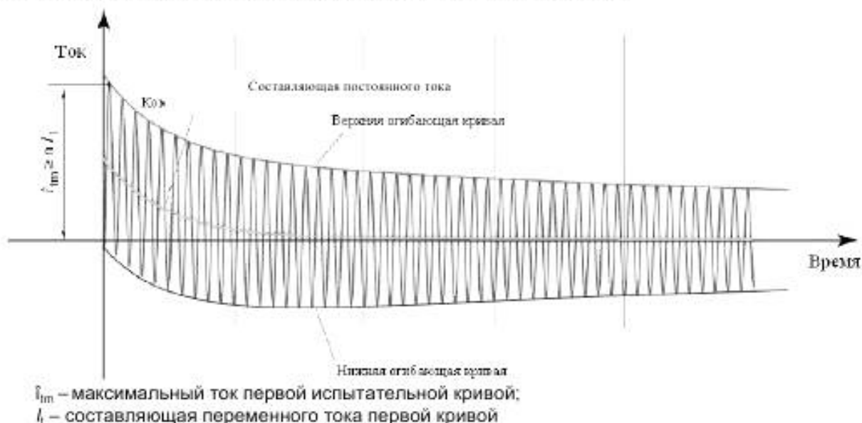
Рисунок 9 – Форма тока короткого замыкания во время испытания
