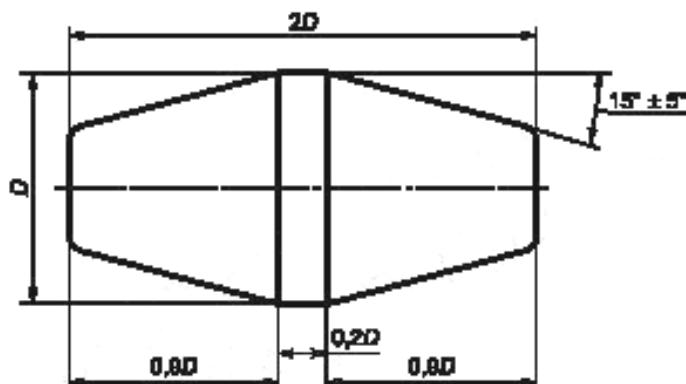
$D$  — 80 % минимального внутреннего диаметра трубной системы, указанного изготовителем
