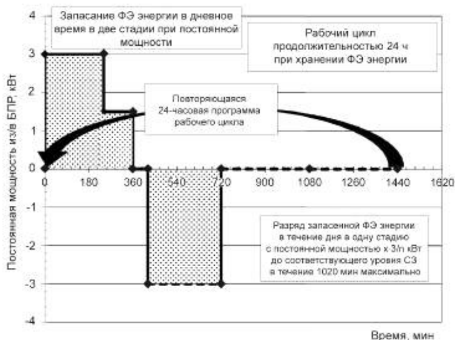
Рисунок 14 — Программа суточного режима с временным сдвигом для фотоэлектрических систем в соответствии с 6.5 — режим 3 кВт
