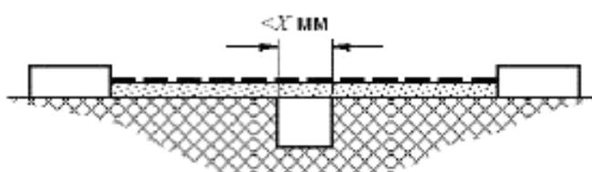
Условие: рассматриваемое расстояние утечки проходит через желобок с параллельными или сходящимися боковыми стенками любой глубины при ширине менее  $X$  мм.
