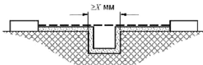
Условие: рассматриваемое расстояние утечки проходит через желобок с параллельными боковыми стенками любой глубины шириной  $X$  мм или более.
