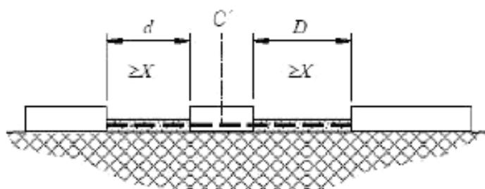
Размер воздушного зазора равен  $d+D$ ; Расстояние утечки равно  $d+D$ ;  $C'$  – свободно движущаяся часть.
