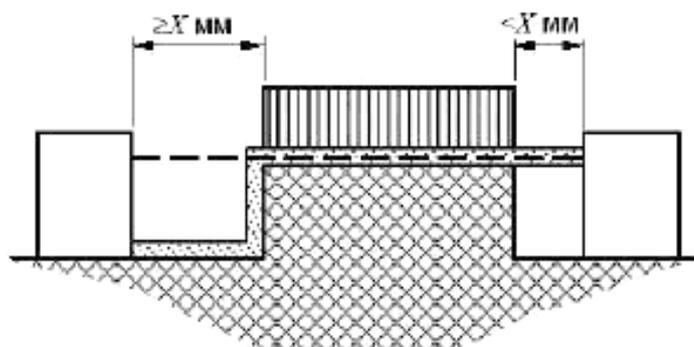
Условие: в рассматриваемое расстояние утечки входит нескрепленный стык с желобком шириной менее  $X$  мм с одной стороны или  $X$  мм и более с другой стороны.
