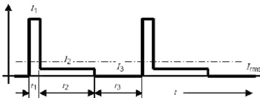
Рисунок Е.6 – Пример среднего расчета теплового эффекта
