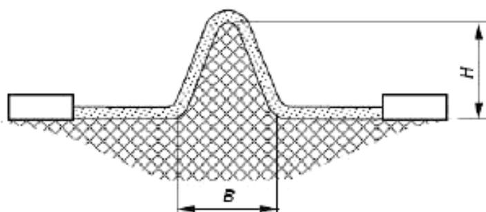
$H$  – минимальная высота ребра 2 мм;  $B$  – минимальная ширина основания, соответствующая требованиям к механической прочности
