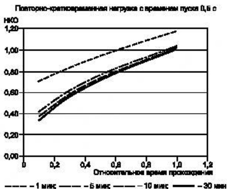
Рисунок Е.7 — Графический пример соотношения между эквивалентным НКО и параметрами при повторно-кратковременном режиме t_1 = 0,5 с, I_1 = 7 \times I_2 для разного времени цикла
