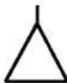
Рисунок 24 — Обозначение окончания работ
