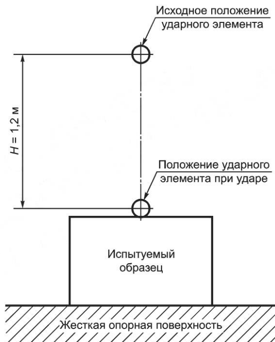
Рисунок 101 — Испытание на удар горизонтальной поверхности
