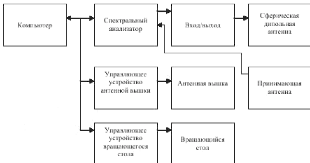
Рисунок 1 – Типовая установка для испытаний (как указано на рисунках с 3 по 8, антенны должны быть выбраны, как описано в 3.3.2 и 3.3.3)
