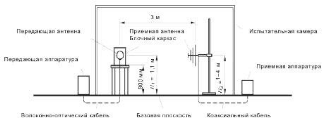
Рисунок 8 – Установка для измерения рассеяния силы сигнала поля E2 (блочный каркас)
