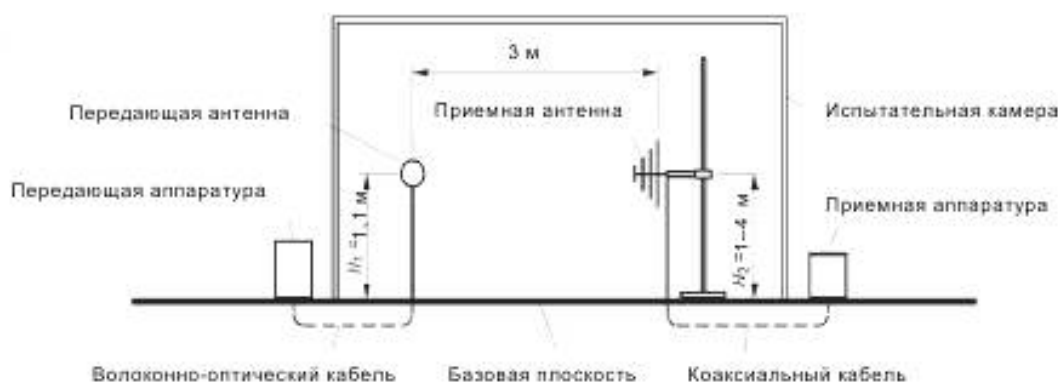
Рисунок 6 – Установка для измерения силы сигнала эталонного поля E_1
