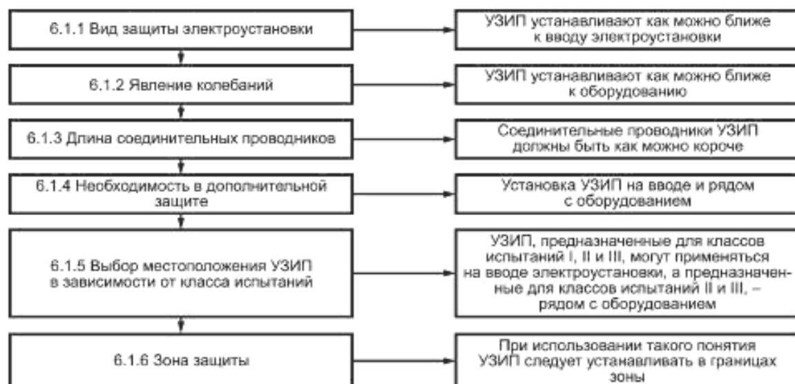
Рисунок 9 — Информационная схема применения УЗИП
